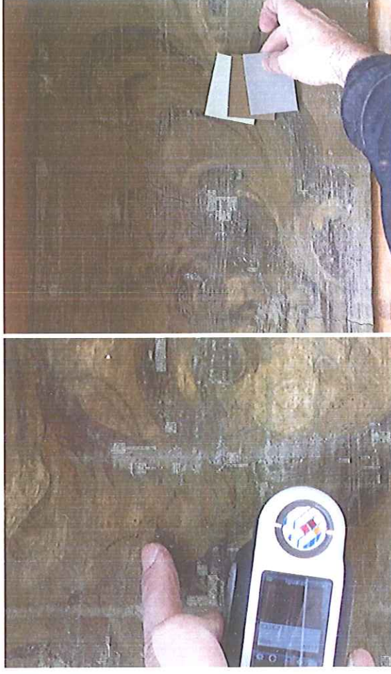
Lectura amb colorímetre portàtil d'una superfície pintada i contrapatat amb les cartolines patró.
